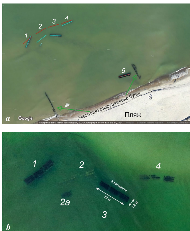
Рис. 3. Первоначальное и окончательное расположение модулей волнолома «Гребенка»: a – исходное (красные линии) и итоговое (голубые линии) расположение модулей (снимок Google Maps , 2021 г. URL: https://www.google.ru/maps ); b – расположение модулей волнолома «Гребенка» на 12.04.2023 г.
