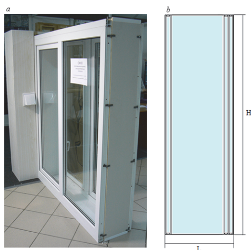
РИС. 2. Теплозвукоизоляционное окно с воздухообменным клапаном: (а) — общий вид; (б) — 2D-сечение; L = 0,264 м; H = 1,470 м.
