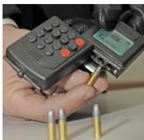
Рисунок 4 – Мобильный телефон со встроенным огнестрельным оружием
