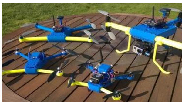
Рисунок 12 – Серия БПЛА, созданных с применением технологии 3D-печати
