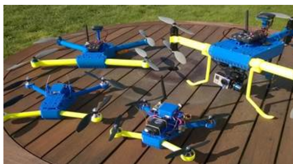
Рисунок 12 – Серия БПЛА, созданных с применением технологии 3D-печати
