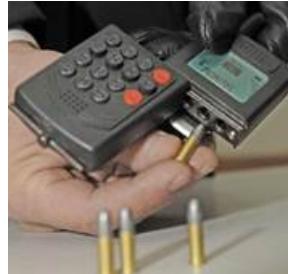
Рисунок 4 – Мобильный телефон со встроенным огнестрельным оружием
