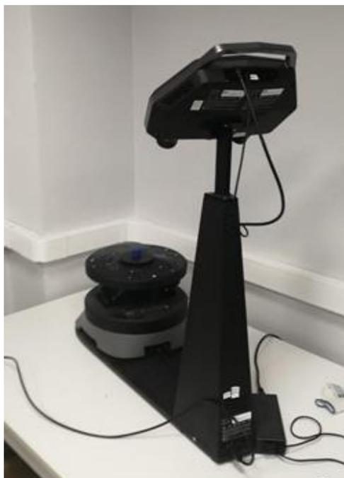
Рисунок 2 – 3D сканер Solutionix C500
