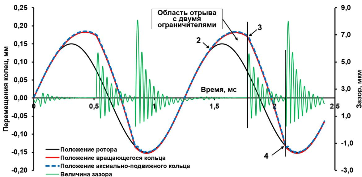
Рисунок 7 – Перемещения колец и изменение зазора в уплотнении
