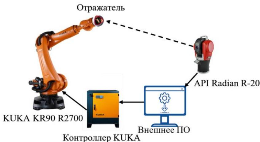
Рисунок 1 – Схема автоматизированного технологического комплекса
