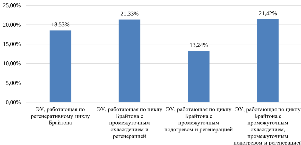
Рисунок 10 – Показатели эффективности циклов ЭУ при эффективной мощности 75,5 кВт
