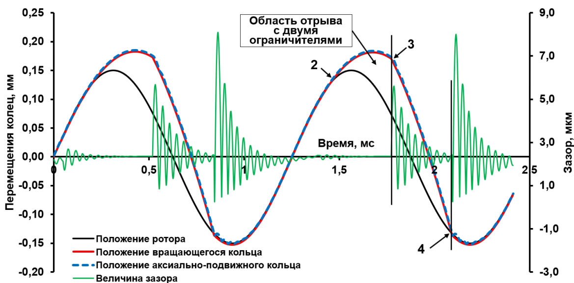
Рисунок 7 – Перемещения колец и изменение зазора в уплотнении
