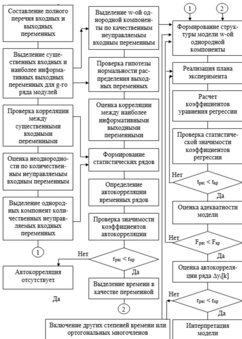
Рис. 1. Структура алгоритма позволяющего выделять однородные модули в киберфизической системе с учетом влияния внешних факторов
