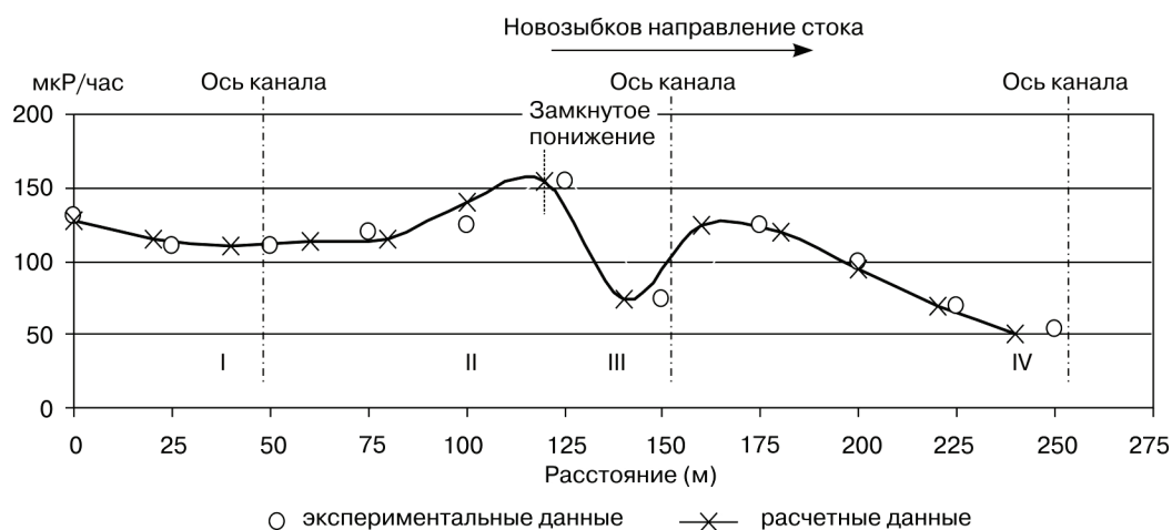
Рис. 3. Влияние осушительных каналов на распределение радиации по территории ○ экспериментальные данные × расчетные данные
