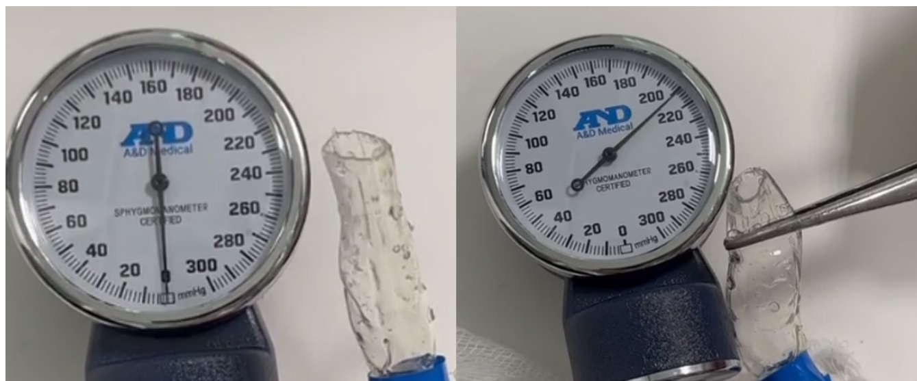
Рис. 6. Тестирование гидрогелевой конструкции на устойчивость к давлению
