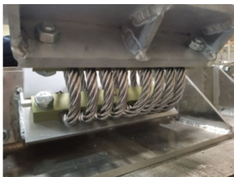
Рис. 1. Спирально-тросовый амортизатор: a — внешний вид; б — конструктивная схема (1 — трос; 2 — планки) Источник: выполнено Е.М. Рейзмунт, С.В. Дорониным
