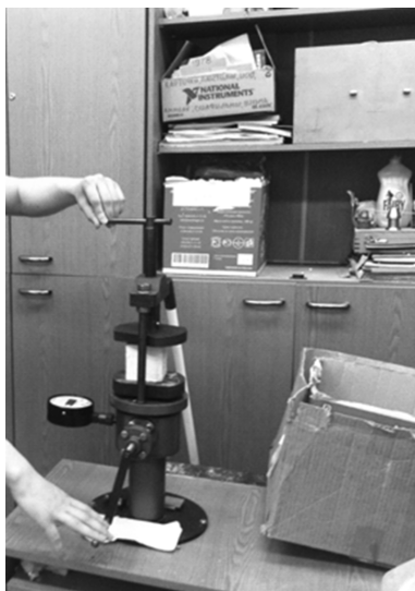
Рис. 3. Сжатие образцов на прессе на 7-е и 28-е сутки
