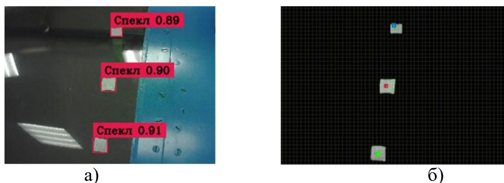
Рисунок 9 – Нейросетевая обработка установленных маркеров на остеклении кабины самолета
