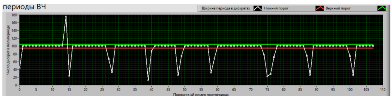
Рисунок 10 – Получаемый набор точек с измерителя полупериодов и визуализация двойного порога
