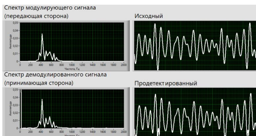
Рисунок 2 – Глубина модуляции 1.4, искажения незначительны, восприятие речи возможно
