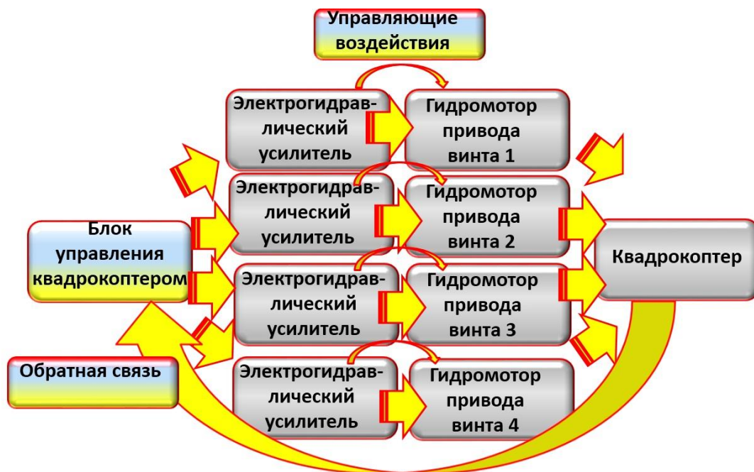
Рисунок 5 – Функциональная схема системы управления квадрокоптера
