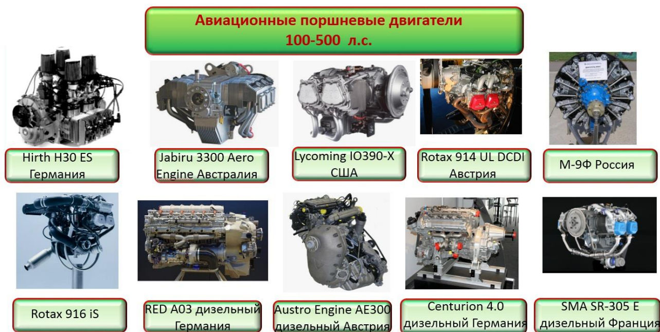
Рисунок 2 – Авиационные поршневые двигатели для привода трансмиссии грузового квадрокоптера
