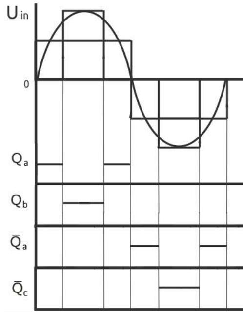
Рисунок 7 – Ступенчатая аппроксимация синусоиды и управляющие импульсы
