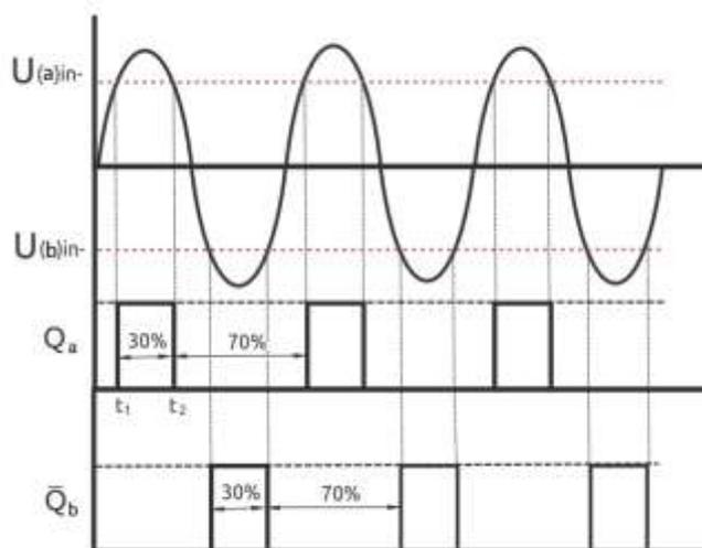
Рисунок 6 – Изменение скважности импульса на выходе компаратора
