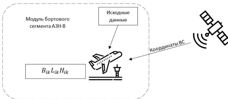
Рисунок 2 – Определение координат ВС при помощи ГНСС
