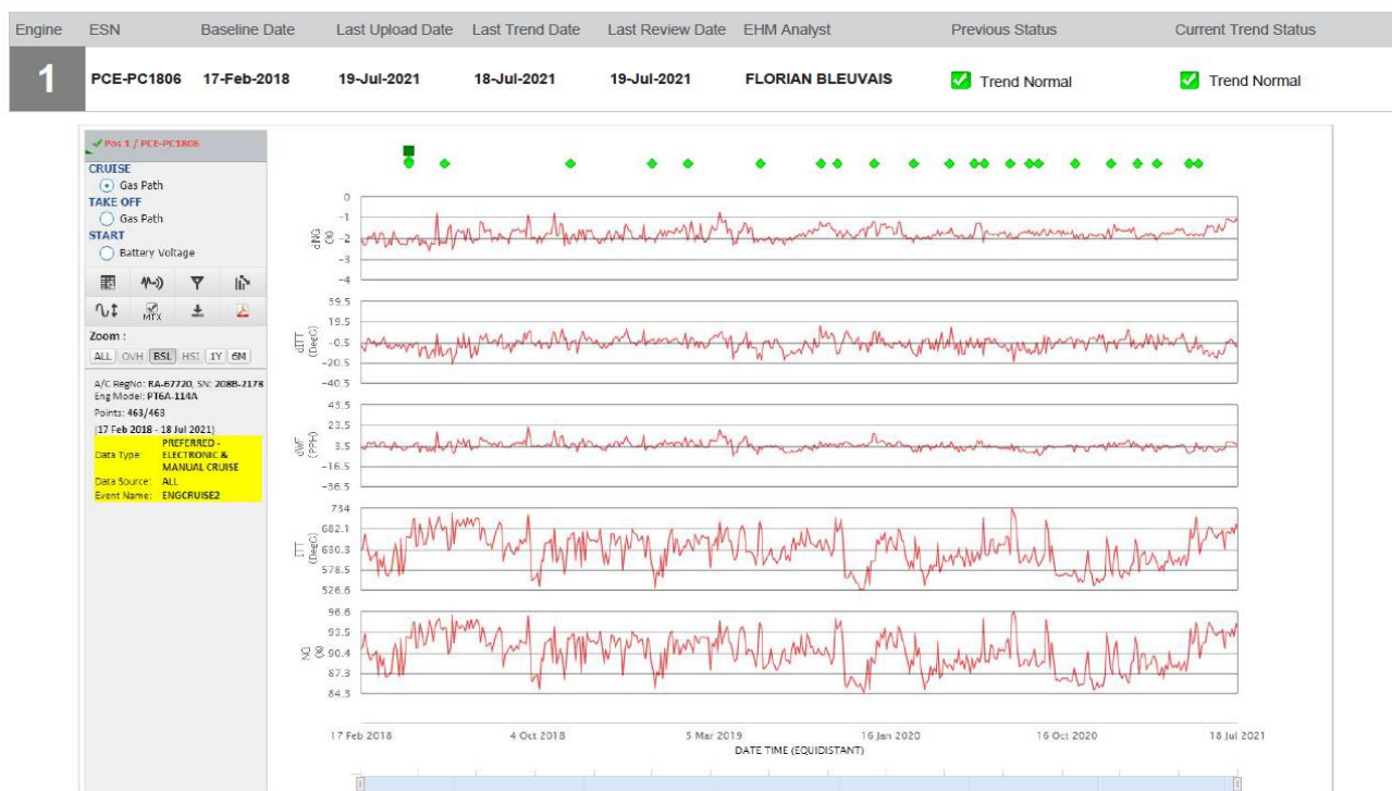
Рисунок 2 – Пример отчета аналитической службы Camr о состоянии двигателя на основании анализа тенденций изменения его параметров
