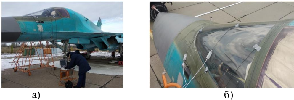
а) – подготовка АПК АЭ к работе; б) – размещение датчиков АЭ на кабине Рисунок 2 – Аппаратно-программный комплекс акустико-эмиссионной диагностики
