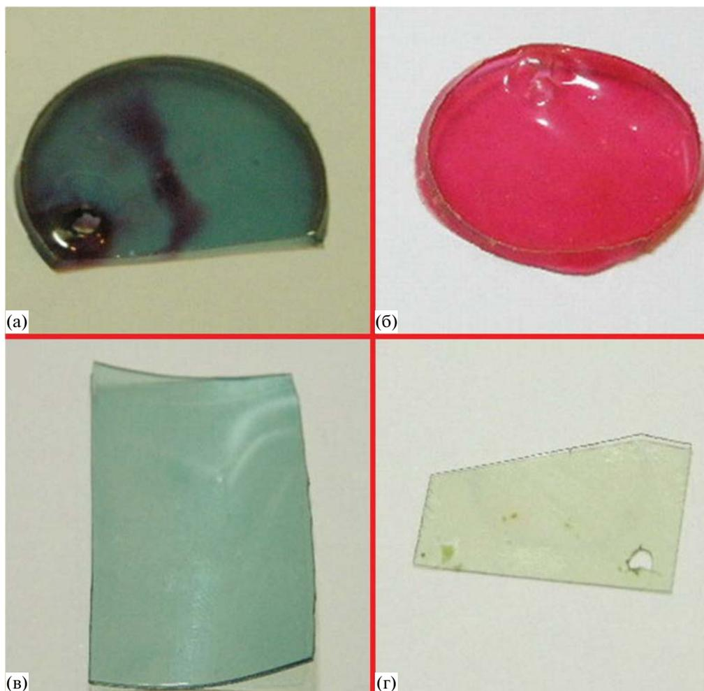
Рис. 8. Фотографии образцов ПВХ (а), Φ-42 (б), ПК (в) и ПЭ (г) после их импрегнации молекулами САО в среде сверхкритического  $\text{CO}_2$ .
