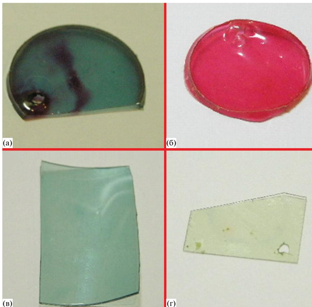
Рис. 8. Фотографии образцов ПВХ (а), Ф-42 (б), ПК (в) и ПЭ (г) после их импрегнации молекулами САО в среде сверхкритического  $\text{CO}_2$ .
