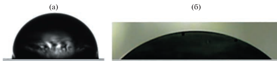
Рис. 6. Микрофотография капли воды на поверхности исходной пленки ПП (а) и нанокмпозита ПП–ПВС с содержанием ПВС 39 мас. % (б). Краевой угол смачивания 98° (а) и 42° (б).
