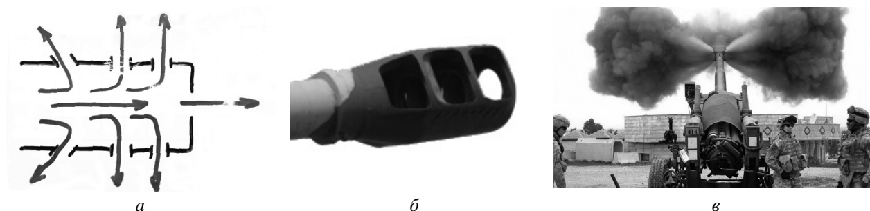
Рис. 1. Компенсации отдачи дульным тормозом:
