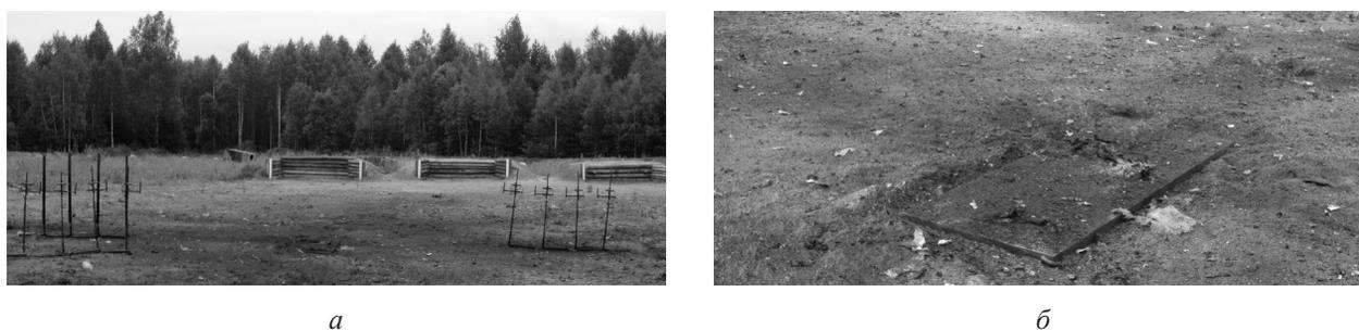
Рис. 7. Вид мишенной обстановки после проведения подрыва заряда ТНТ массой 2,0 кг с использованием штатного УЗВ «Фонтан-1» модели 20К: а — общий вид мишенной обстановки; б — вид плиты, на которой размещался УЗВ «Фонтан-1» модели 20К
