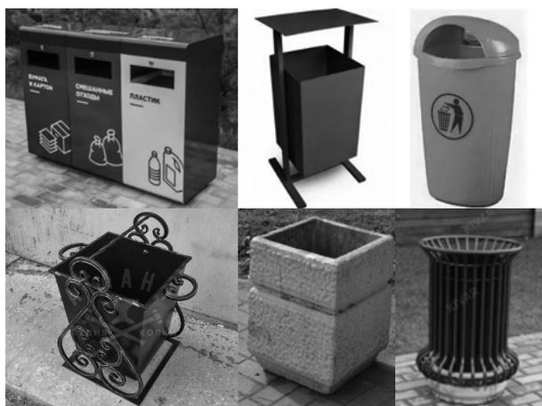
Рис. 1. Вид урн (контейнеров) для сбора бытовых отходов
