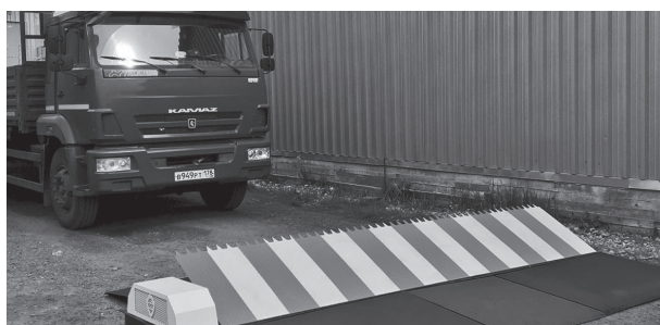
Рис. 4. Вид комбинированного дорожного блокиратора с шипами
