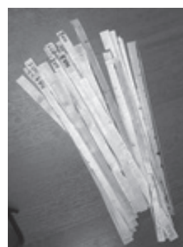
Рис. 3. Образцы из СВМПЭ-волокна для определения модуля Юнга
