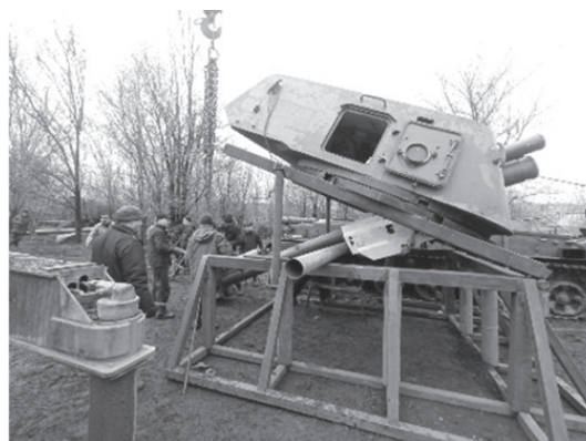
Рис. 4. Организация замены ствольно-затворной группы на изделиях АВ
