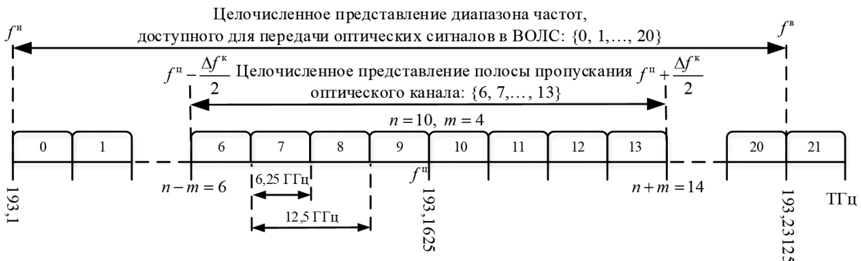
Рис. 2. Доступный диапазон частот и полоса пропускания оптического канала
