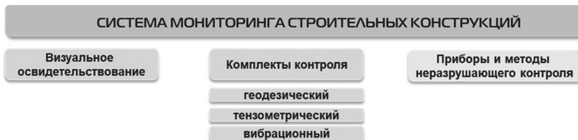
Рис. 3. Общая схема системы мониторинга технического состояния строительных конструкций
