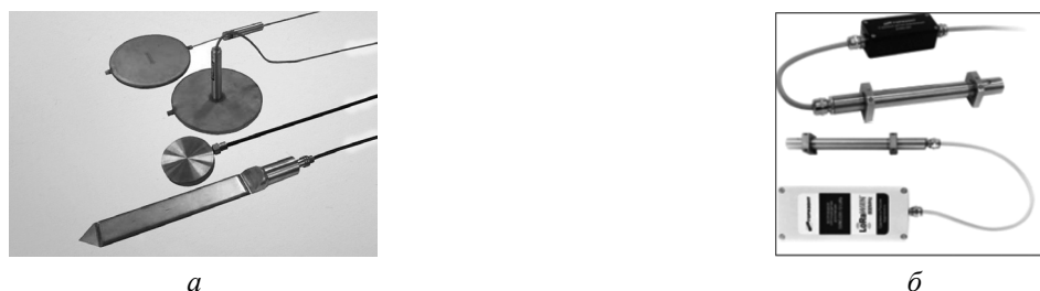
Рис. 4. Струнные преобразователи неэлектрических величин: а — давления; б — деформации
