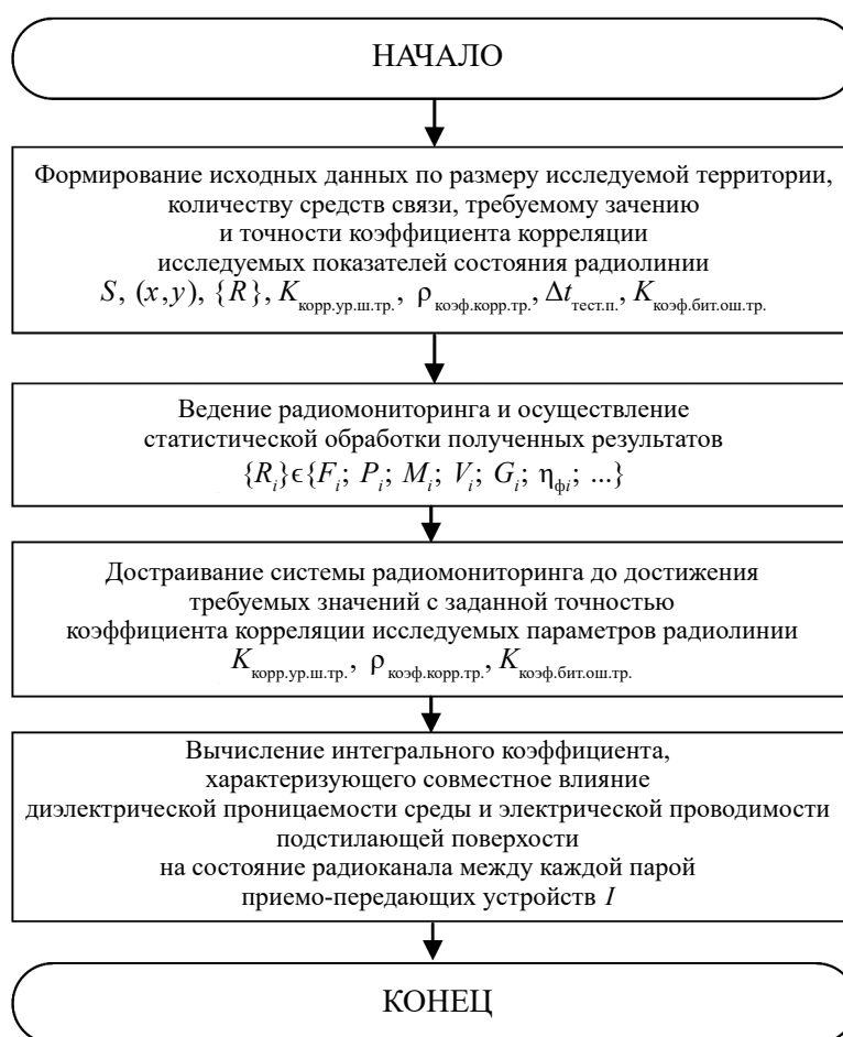
Рис. 3. Обобщенная структура блок-схемы методики оценки функционирования сети абонентского радиодоступа
