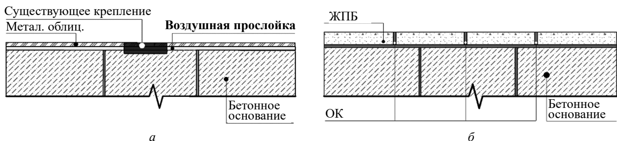
Рис. 1. Варианты применения облицовки газохода: а — из металлооблицовки; б — из ЖПБ
