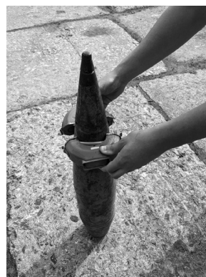
Рис. 6. Размещение КЗК на артиллерийском снаряде перед его обезвреживанием
