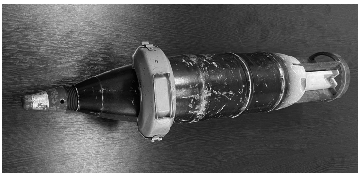
Рис. 7. Размещение полукольцевого заряда КЗК на артиллерийском снаряде перед его обезвреживанием
