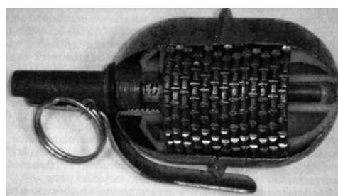
Рис. 4. Граната, используемая во время конфликта в Нагорном Карабахе, имеет диаметр — 60 мм, толщину проволоки — 3 мм, количество полуготовых поражающих элементов — 480 шт.
