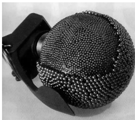
Рис. 2. Швейцарская граната HG-85 (модифицированная), в качестве поражающих элементов используются вольфрамовые шарики [4]
