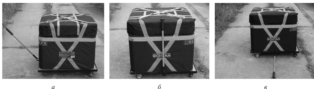
Рис. 1. Вид мобильного комплекса локализации взрыва на основе УЗВ контейнерного типа «Фонтан-1» модели 20К с различным положением транспортной ручки тележки: а — при применении по назначению; б — в положении, перпендикулярном земле; в — в положении, параллельном земле
