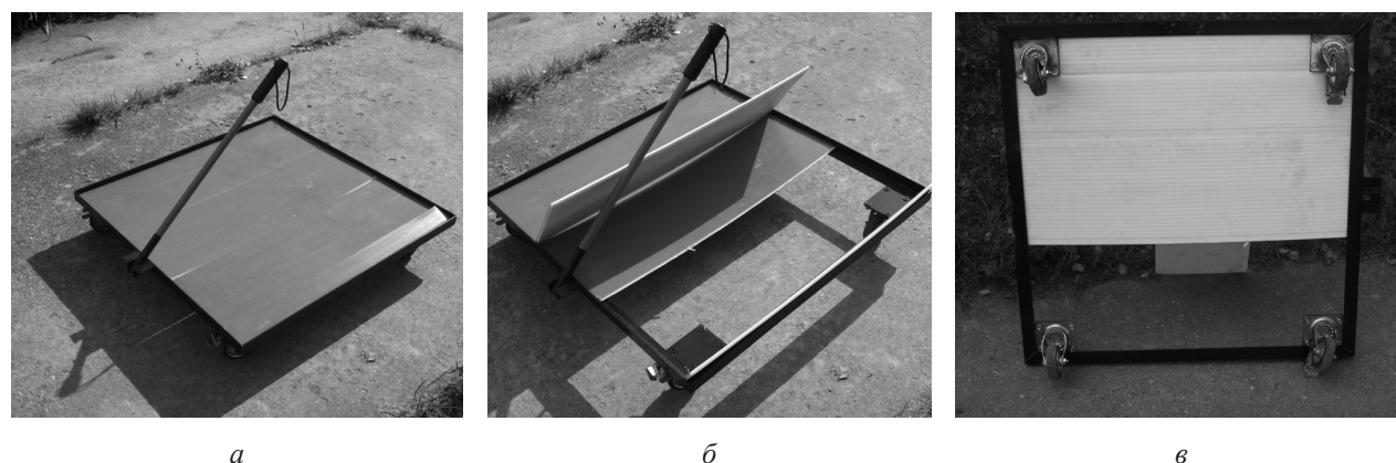
Рис. 2. Вид транспортировочной тележки: а — общий вид; б — вид со снятой панелью заполнения каркаса; в — вид тележки снизу
