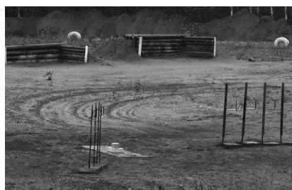
Рис. 4. Вид заряда ТНТ массой 2,0 кг (а) и мишенной обстановки (б) перед открытым подрывом
