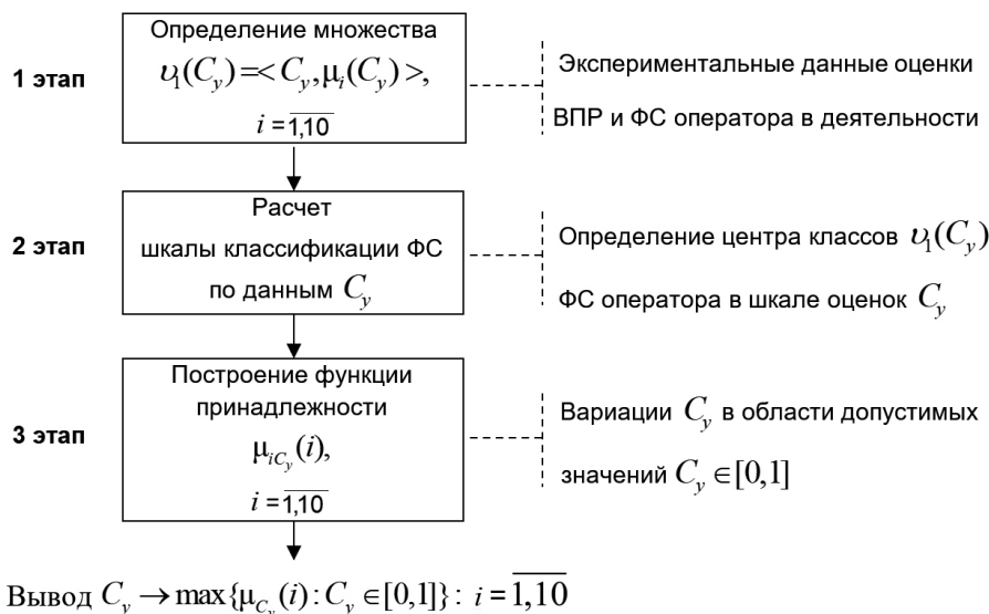
Рис. 1. Структурная схема определения значений параметров работоспособности оператора для различных его функциональных состояний i = \overline{1,10}
