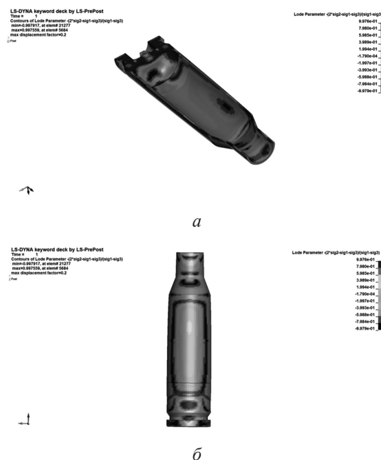
Рис. 6. Результаты деформации композитной 5,45-мм гильзы: а — суммарная силовая нагрузка в изометрии; б — суммарная силовая нагрузка внешней стенки
