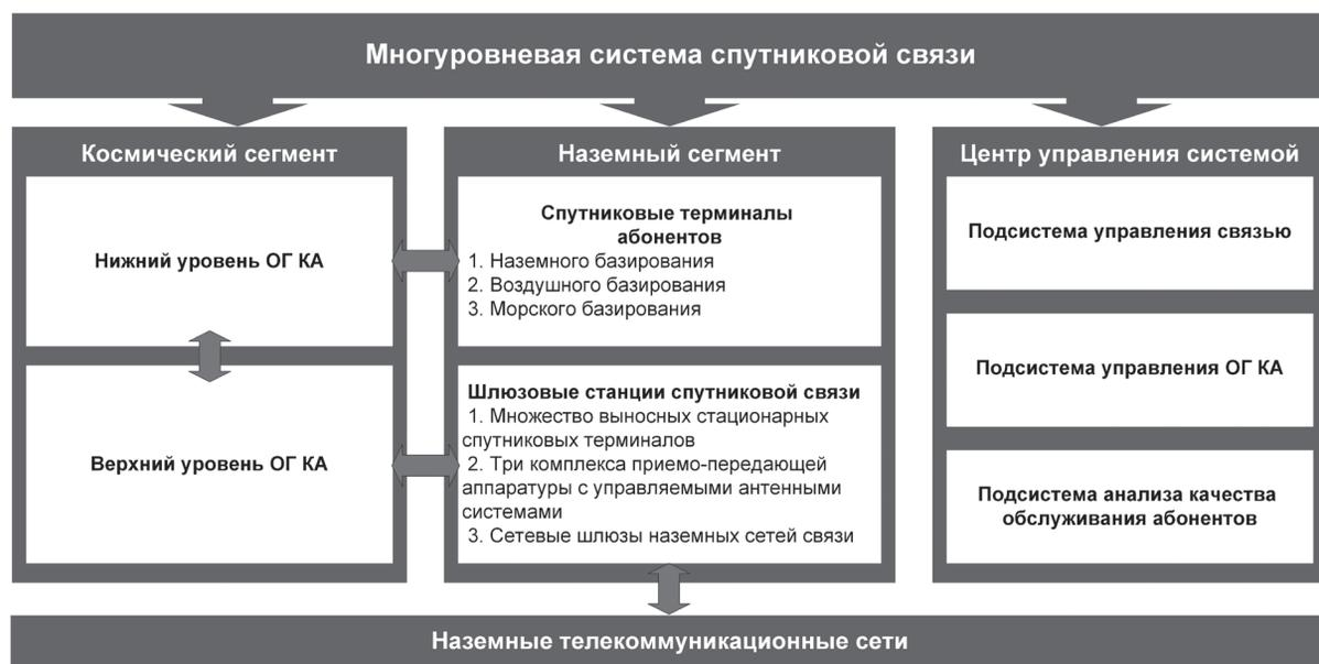
Рис. 1. Структурная схема многоуровневой ССС
