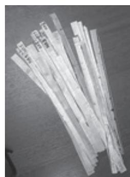
Рис. 3. Образцы из СВМПЭ-волокна для определения модуля Юнга
