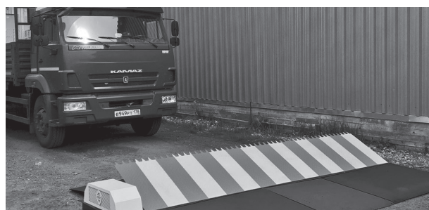
Рис. 4. Вид комбинированного дорожного блокиратора с шипами
