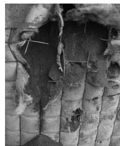
Рис. 13. Вид поражений ГНТ-2 с лицевой стороны элементами гранат ПГ-7ВЛ
