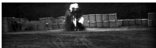
Рис. 10. Кинограмма взаимодействия гранаты ПГ-7ВЛ с изделием «Лоза» и ГНТ-2
