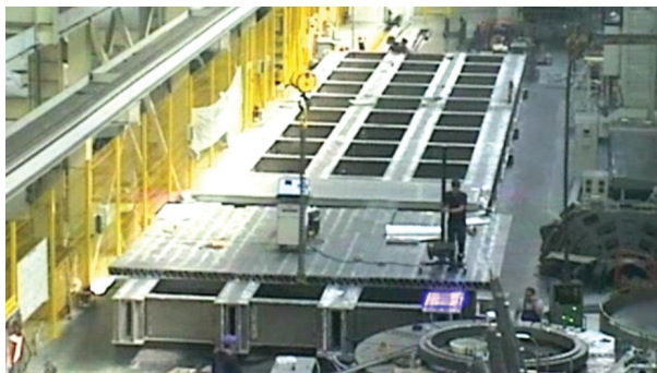
Рис. 16. Контрольная сборка элементов пролетного строения на заводе
