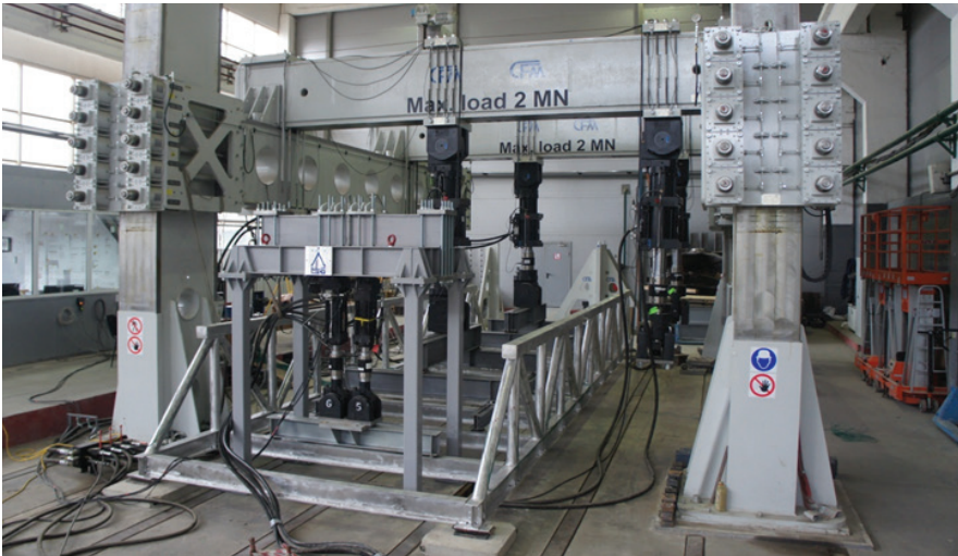
Рис. 11. Испытания на выносливость несущего каркаса пешеходного моста на испытательном стенде НИУ МГСУ
