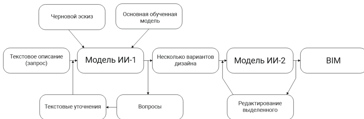
Рис. 3. Концепция идеального интегрированного рабочего процесса для проектирования с применением искусственного интеллекта Fig. 3. The concept of an ideal integrated workflow for AI-enabled design
