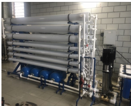
Рис. 4. Мембранные установки, оснащенные мембранами обратного осмоса 8040 и модулями открытого канала 4040 для снижения расхода концентрата и повышения извлечения Fig. 4. Membrane units equipped with 8040 reverse osmosis membranes and 4040 open channel modules to reduce concentrate consumption and increase recovery
