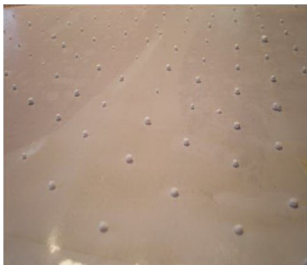
Рис. 2. Принципы построения и работы мембранного элемента с открытым каналом: a – поток концентрата в открытом канале, образованном пластиковыми шариками, приклеенными к мембране; b – фотография мембраны с приклеенными шариками Fig. 2. Principles of construction and operation of the open channel: a – concentrate flow in an open channel formed by plastic balls glued to the membrane; b – photograph of the membrane with glued balls
