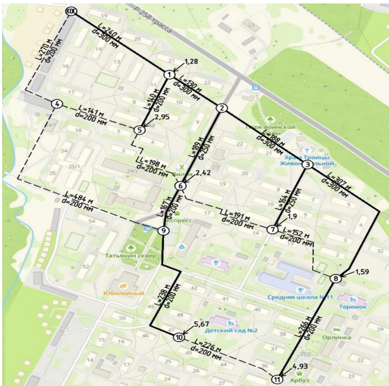
Рис. 2. Расчетная схема системы водоотведения района Южный г. Байкальск Fig. 2. Calculation scheme of the drainage system of the Yuzhny district of Baikalsk
