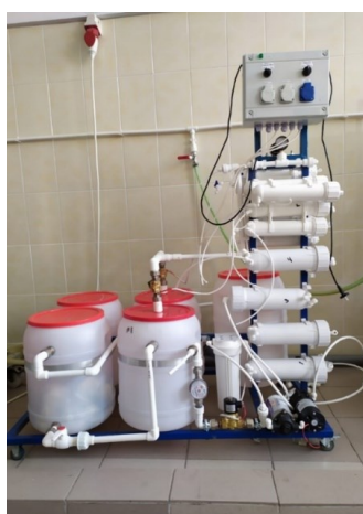
Рис. 18. Пилотная установка, изготовленная с использованием модулей открытого канала для снижения расхода концентрата, работающая в непрерывном режиме.
