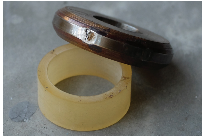
Рис. 7. Образец с контактно-усталостной выщербиной
