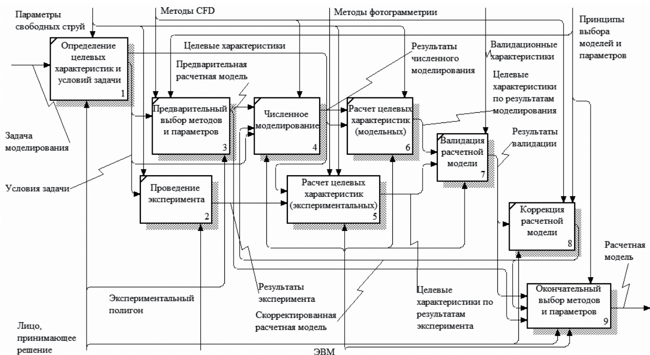
Рисунок 2 – Схема выбора методов вычислительной гидродинамики и их параметров для моделирования свободных струй
