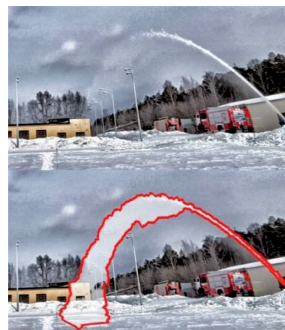
Рисунок 5 – Фрагменты изображения струи огнетушащего вещества из ПЛС после предварительной обработки (вверху) и выделения границ (внизу)
