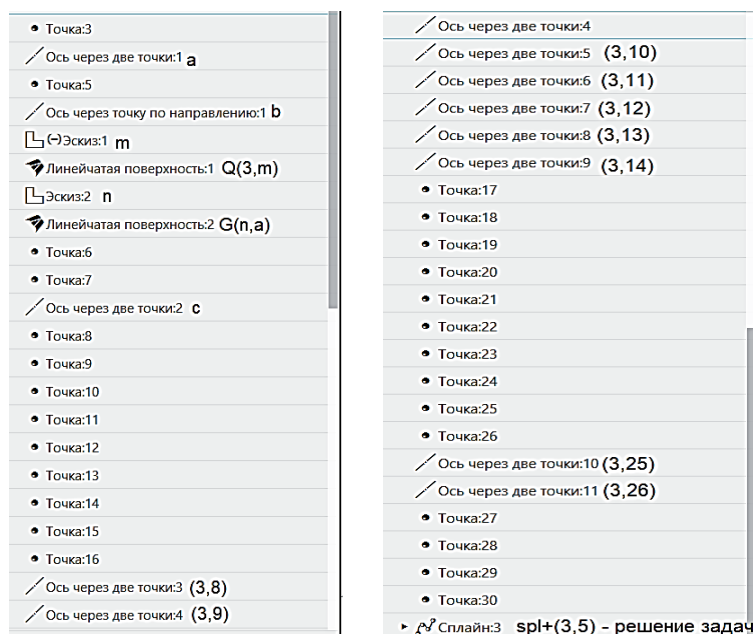
Рисунок 9 – Дерево 3D-моделирования линии пересечения квадрик ( 4=3+1 )
