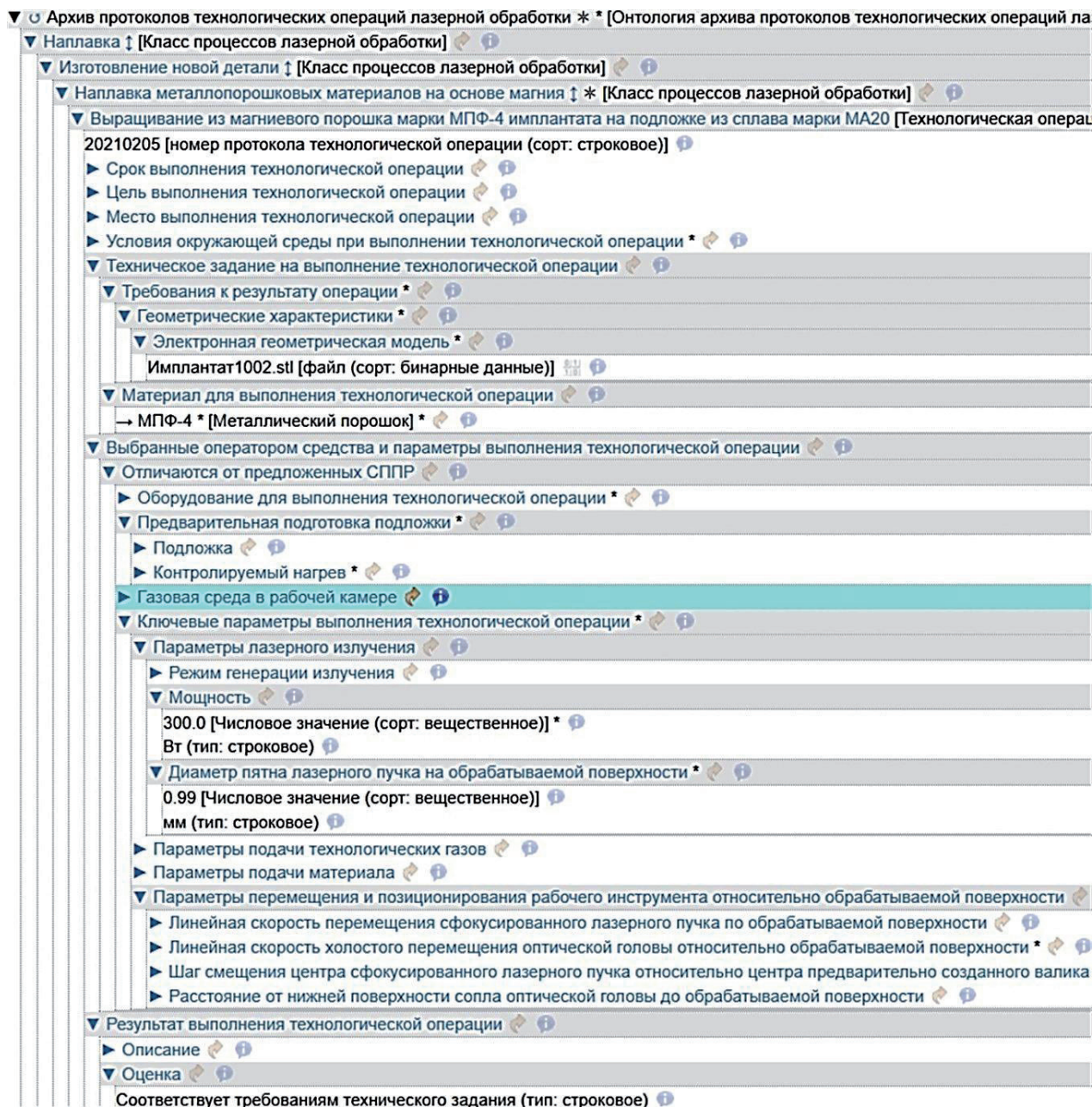
Рисунок 8 – Фрагмент архива протоколов технологических операций лазерной обработки (фрагмент протокола ТО «Выращивание из магниевого порошка марки МПФ-4 имплантата на подложке из сплава марки МА20»)
