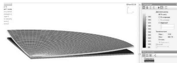
Рис. 4. Модель заготовки после нагрева в газовой печи до 1100 °C
