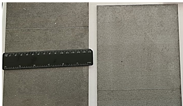
Рис. 1. Пластины толщиной 3,0 мм из сплава АК9, выращенные селективным лазерным плавлением
