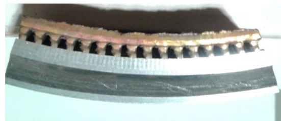
Рис. 2. Профиль корпуса ЖРД с пазами для прохождения охлаждающей жидкости
