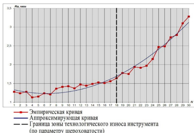
Рис. 5. График зависимости шероховатости обработанной поверхности Ra от количества обработанных участков заготовки N
