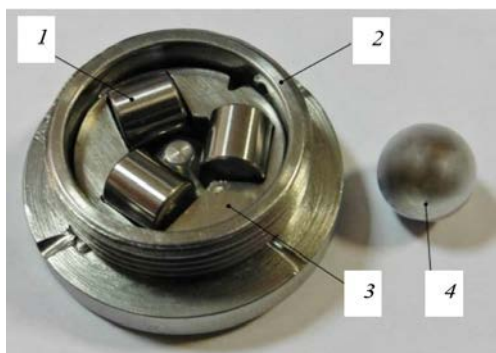
Рис. 1. Модернизированная оправка (накидная гайка снята):
