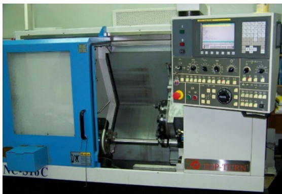
Рис. 1. Общий вид экспериментальной установки на базе токарного станка с ЧПУ TOP TURN CNC-S16C
