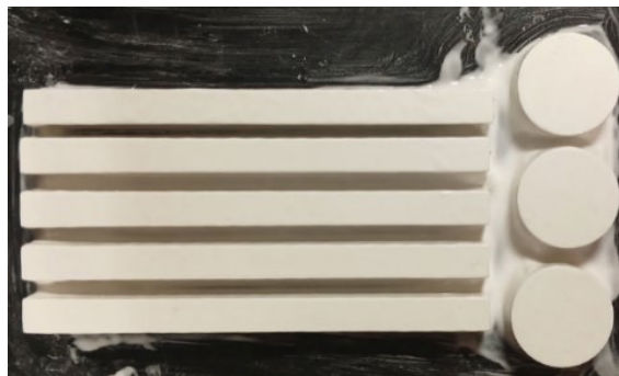
Рис. 3. Напечатанные образцы методом 3D DLP печати
