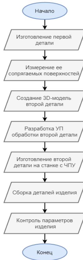
Рис. 2. Блок-схема алгоритма основных вычислительных процедур предлагаемого способа изготовления сборного изделия
